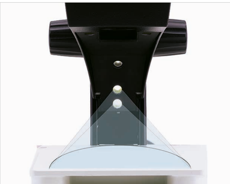
Episcopia en posición 1: los cinco LED encendidos para obtener la máxima intensidad luminosa.
