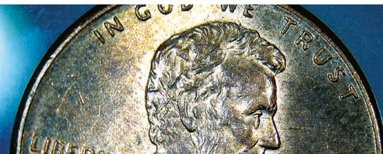
Episcopia en posición 3: los dos LED inferiores proyectan una iluminación plana sobre el objeto de estructura fina, resaltando así el contraste.
