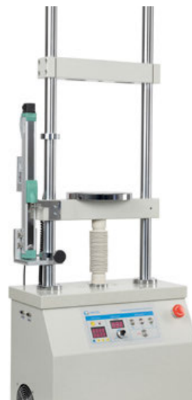
Banco de pruebas motorizado incl. sistema de medición de longitud LD
