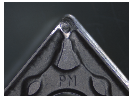
Inserto indexable, muestra el desgaste de la herramienta. Luz reflejada, anillo de luz, zoom 0,8x
