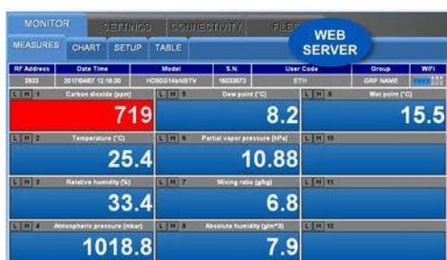
Servidor web: monitor de mediciones con medición de CO2 en alarma
